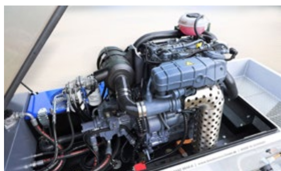
Motor DEUTZ TD 2.2 con unidad hidráulica
