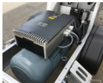
Motor eléctrico de 22 kW
